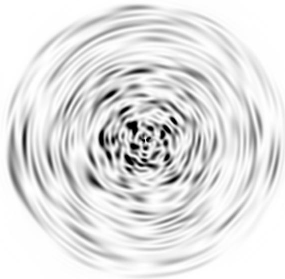
Рис. 4.15. Смоделированное распределение интенсивности выходящего излучения (инвертированное изображение) при ограниченном значении максимального азимутального индекса мод в соответствии с формулой (4.2.13) при  $l_e=10$  для ВС с  $r_0=100$  мкм,  $n_A=0.1$  при  $\lambda=0.633$  мкм.
