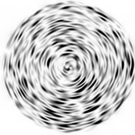
Рис. 4.18. Смоделированное распределение интенсивности выходящего излучения при ограниченном значении максимального азимутального индекса мод в соответствии с формулой (4.2.16) при  $m_e=3$  для ВС с  $r_0=100$  мкм,  $n_A=0.1$  при  $\lambda=0.633$  мкм.
